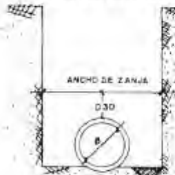
ZANJA SIN ENTIBADO
